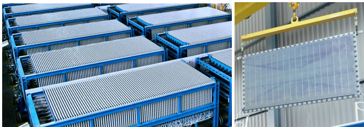
Figura 29 – Dettaglio delle celle elettrochimiche PEM
