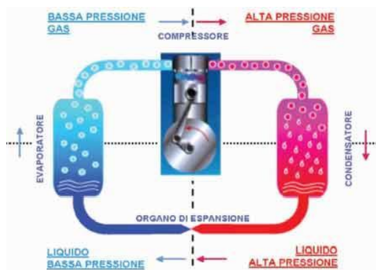
Figura 33 - Schema del ciclo frigorifero
